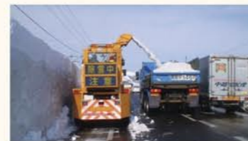
運搬排雪の状況
