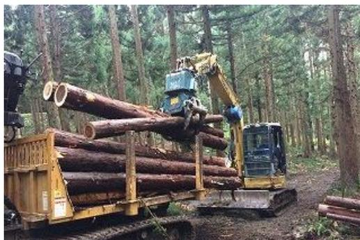
【高性能林業機械による集材作業】
