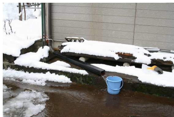
写真 3-1(3) 屋根散水の状況と散水量の簡易計測（2007 年 2 月 2 日）
