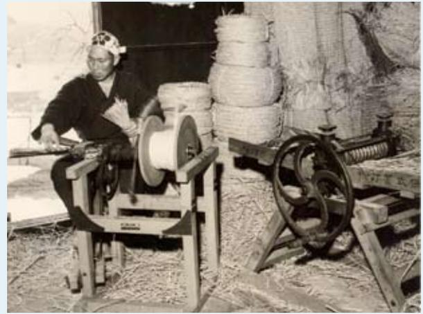
右の写真は、昭和30年3月、旧六日町之上で撮影。冬の間は、出稼ぎか藁仕事くらいしか賃仕事はありませんでした。▼右の機械は、藁をつぶして柔らかくする藁打ち機。その藁束を左手に持ち、右手で数本づつ縄ない機械に続いていきます。駆動は、両足を交互に踏むことにより、回転運動に変えます。両手両足をフルに動かして縄をなっています。▼後に積んである縄は、太さにより玉の大きさが違ってきます。稲架（ハサ）がけや雪囲いに多く使用しました。余分なものは、出荷して現金収入になりました。
