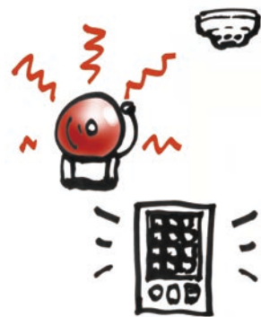
自動火災報知設備
